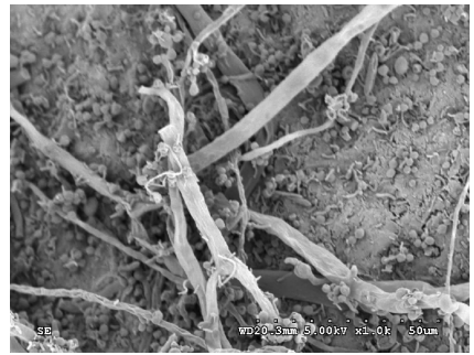
图 6 活性炭表面电镜照片 (×1 000) Fig. 6 Electron microscope of active carbon surface with microorganism (×1 000)
